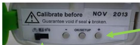
Boutons de navigation et de sélection suivant le mode sélectionné
